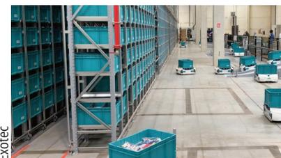
Ces robots là ont la capacité de se déplacer en 3D. Pour aller chercher les bacs, ils montent et descendent au sein de la structure composée de racks standards. Une fois au sol, en toute autonomie, ils apportent directement la marchandise au préparateur.
